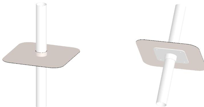
Maß für Kernbohrung  $\varnothing$  70 mm
