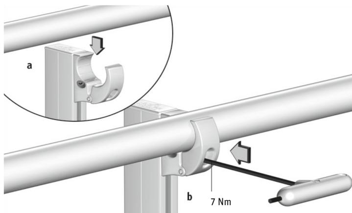
Mit der seitlich zugänglichen Schraube M5 x 18 (TX0036) ist eine nachträgliche Höhenjustierung der Geländerprofile jederzeit möglich. Mit dem Innensechskantschlüssel Nr. 4 wird der Halter am Stützenprofil leicht gelöst, der Halter im Nutprofil in die gewünschte Position gebracht und wieder arretiert.
