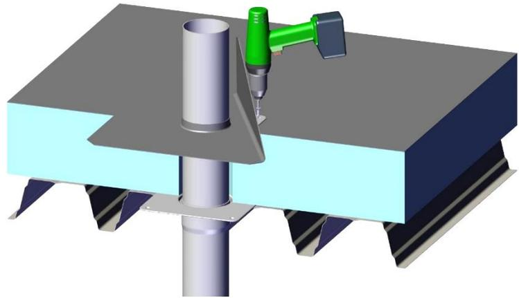
**Schritt 7** Die Anschlussmanschette der b/s/t Kabeldurchführung fachgerecht mit der Dachabdichtungsbahn verschweißen.
