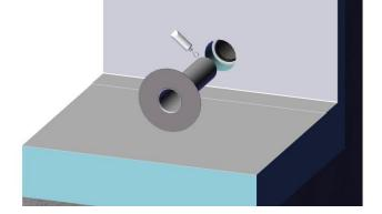
Schritt 4 Den b/s/t Notüberlauf durch das Grundelement schieben.
