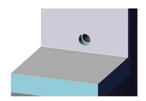
Schritt 3 Um eine sichere Verbindung und Dichtigkeit zu gewährleisten, muss der b/s/t Notüberlauf durch den Dichtring des b/s/t ALIT Grundelements geschoben werden. Vor dem Einsetzen des b/s/t Notüberlaufs, die Dichtung im b/s/t ALIT Grundelement und den b/s/t Notüberlauf mit Gleitmittel versehen. Entstehende Hohlräume fachgerecht ausfüllen.
