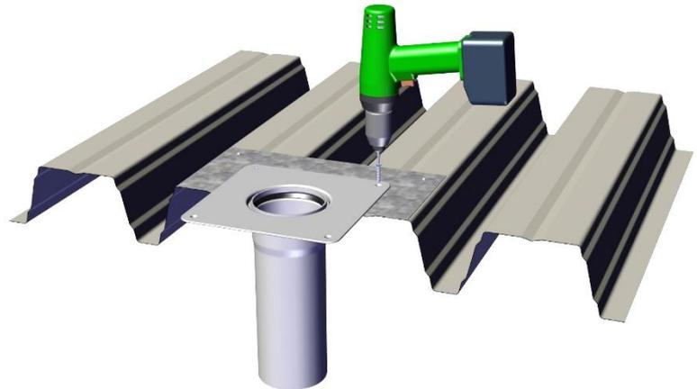
**Schritt 3** Die Dampfsperre fachgerecht aufbringen und mit dem b/s/t PVC Grundkörper gemäß der Herstellerangaben verkleben oder verschweißen.
