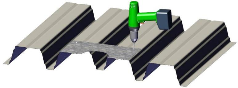
**Schritt 2** Den b/s/t PVC Grundkörper in das Verstärkungsblech einsetzen und entsprechend der Einbausituation fachgerecht mechanisch fixieren.
