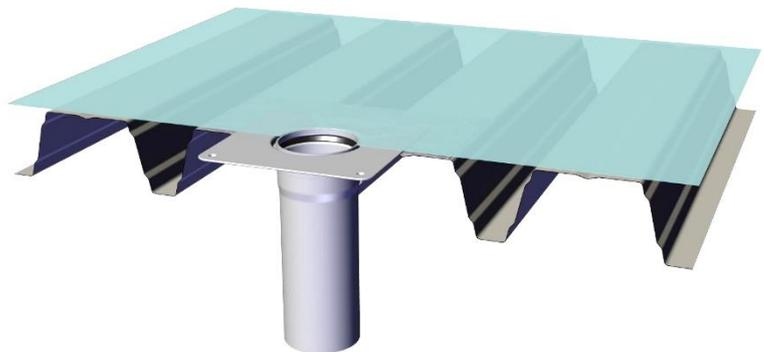
**Schritt 4** Die Wärmedämmung und die Dachabdichtungsbahn fachgerecht gemäß Herstellerangaben aufbringen und entsprechend des Durchmessers der b/s/t Energiedurchführung ausschneiden.
