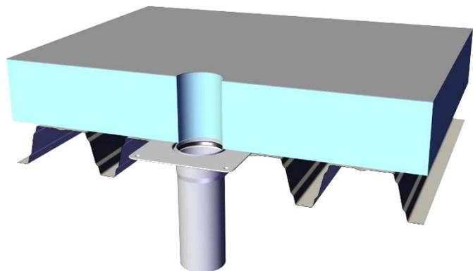
**Schritt 5** Um eine sichere Verbindung und Dichtigkeit zu gewährleisten, muss die b/s/t Energiedurchführung durch den Dichtring des b/s/t PVC Grundkörpers geschoben werden.
