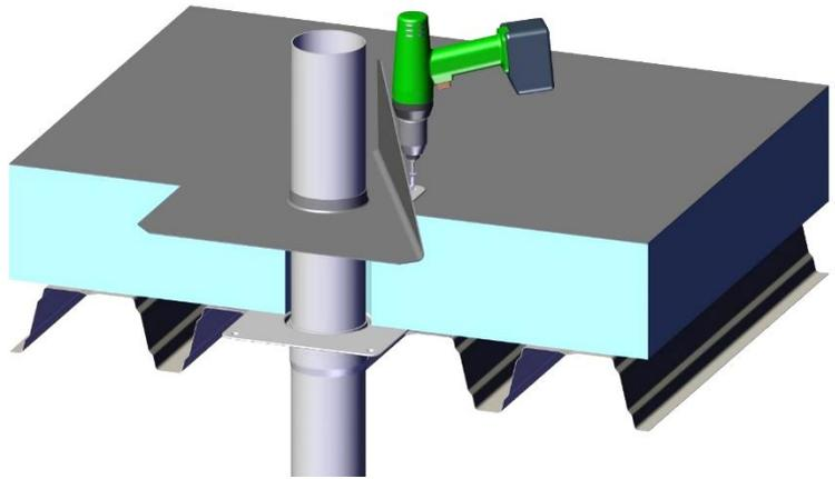
**Schritt 7** Die Anschlussmanschette der b/s/t Energiedurchführung fachgerecht mit der Dachabdichtungsbahn verschweißen.
